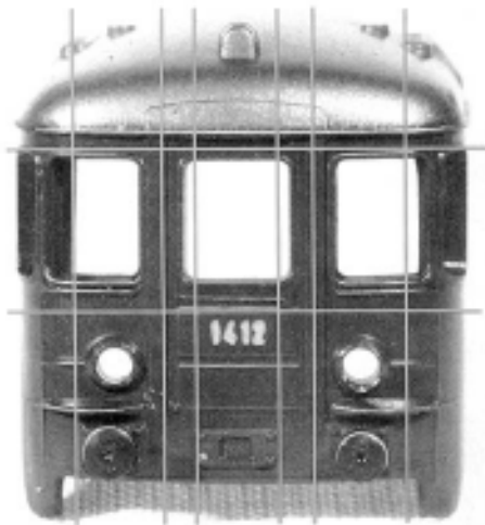
Bild 5 Rund 8 Mal muss die Stirnwand zerschnitten werden, damit die Front um 3 mm schrumpft (Foto Peter Meier)
